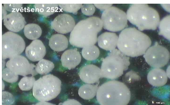
Obrázek 8.: Snímek z optického mikroskopu – průmyslově vyráběné cenosféry [4].
