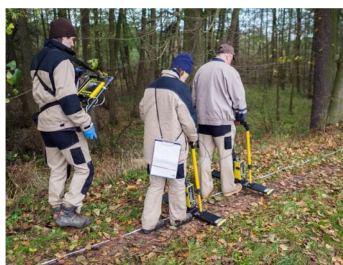
Obrázek 8.: Měření podélného profilu georadarem
