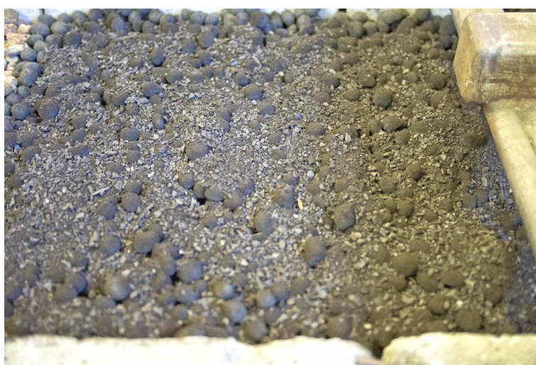
Obrázek 3.: Čerstvá vsázka se zapalovací vrstvou
