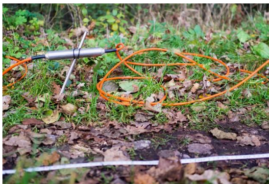
Obrázek 4.: Detail ukotvení měřící sondy
