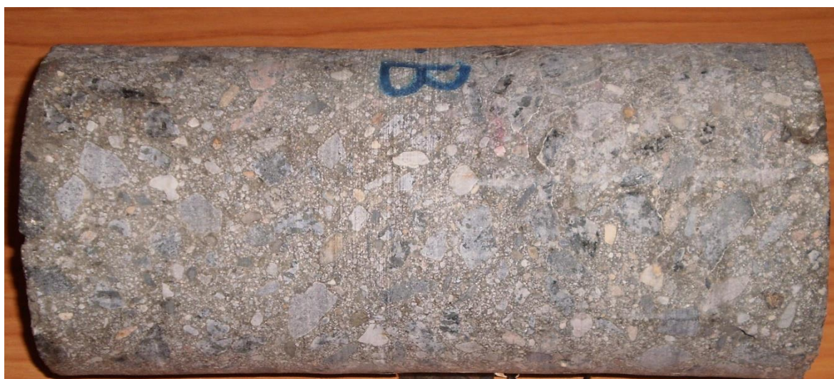
Obr.1 Vývrt z masívní konstrukce po 100 zmrazovacích cyklech – Narušená část teplotním gradientem je 15 cm
