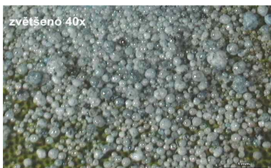
Obrázek 10.: Snímek z optického mikroskopu – cenosféry z popílků elektrárny Opatovice [4].
