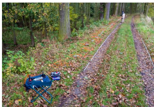
Obrázek 5.: Linie měřících sond včetně měřícího zařízení
