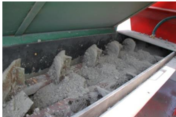
Obrázek 6.: Pohled do dvou vřetenového lopatkového mísiče skrz otevřený kryt homogenizátoru
