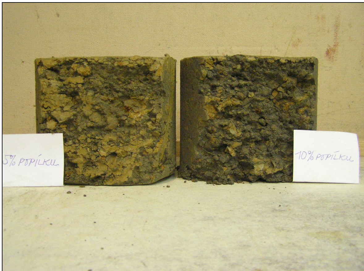
Obrázek 5: Směs zeminy a popílku po zhutnění (5% a 10% popílku)
