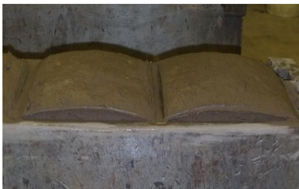
Obrázek 4.: Solidifikáty připravené dle receptury E
