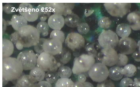
Obrázek 10.: Snímek z optického mikroskopu – cenosféry z popílků elektrárny Opatovice [4].
