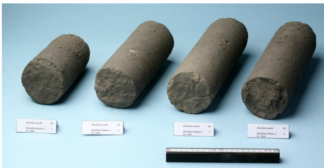
Obrázek 2.: Příklad zkušební těles odebraných technologií vývrtů z jednoho měřícího profilu.
