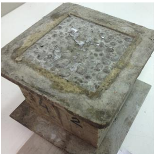
Obrázek 12.: Laboratorní vzorek betonu před odformováním
