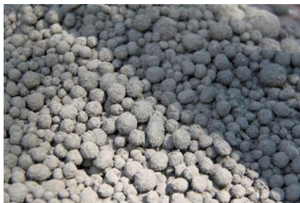
Obrázek 9.:Detail sbalků solidifikátu
