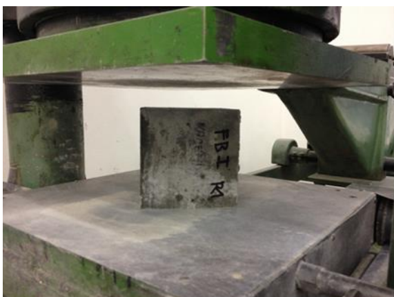
Obrázek 14.: Zkušební vzorek betonu v lisu pro zkoušku pevnosti v tlaku prostém
