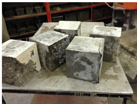
Obrázek 15.: Zkušební vzorky po zkoušce pevnosti v tlaku prostém
